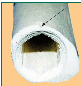
Abb. 1: Hexagonales Implantatbett am Knochenmodell
